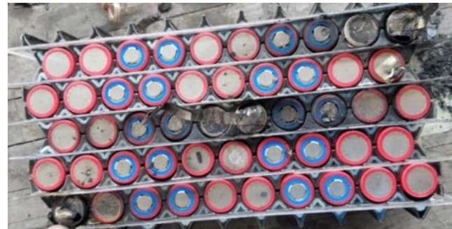
Essais de propagation d'un défaut.
